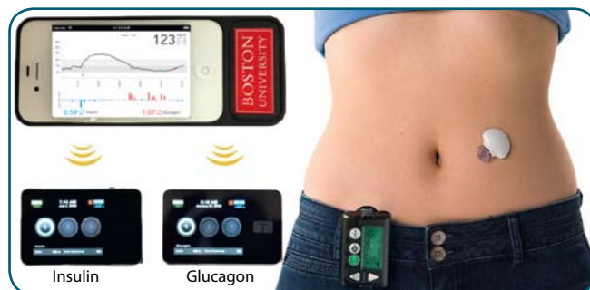
2. attēls. Mākslīgais aizkuņģa dziedzeris (bihormonāls pumpis), un pacienta telefonā atainotais kontroles algoritms (pa kreisi), Glikozes sensors (pa labi)
